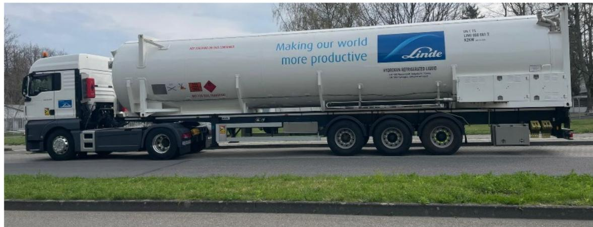
3500 kg LH<sub>2</sub> (flüssiger Wasserstoff bei -253°C)
