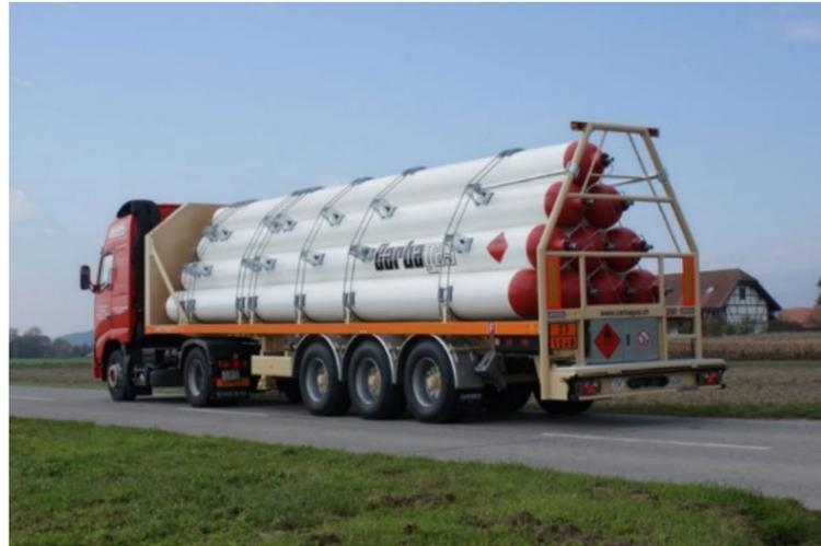
ca. 320 – 360 kg H<sub>2</sub> (Wasserstoff bei 200 bar)
